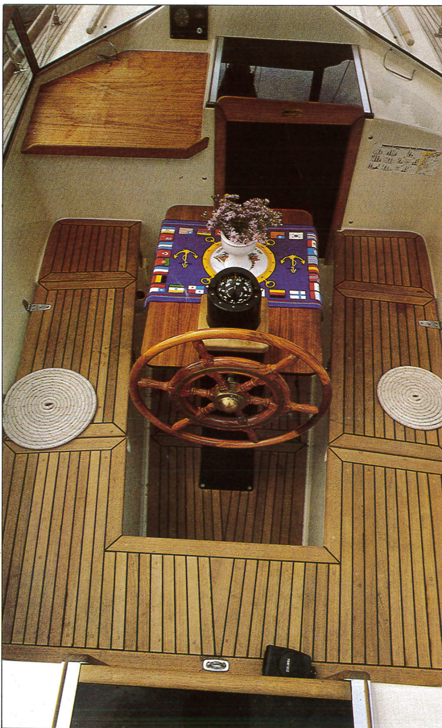
Malö 40 har Edson rattstyrning och en verkligt elegant trärratt. På rattpedestalen sitter också en kompass av högsta kvalitet samt en ensaksreglage för motorn.
