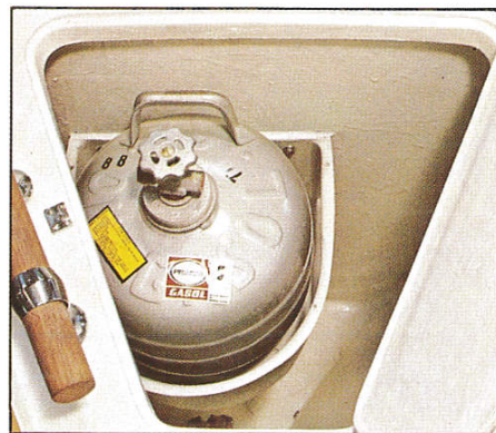
Föröver finns ett dränerat utrymme för gasolflaskan. Här finns också plats för tampar och ankare. Ett motsvarande utrymme finns också akterut – lämpligt för ankare, fendrar, kätting etc.
